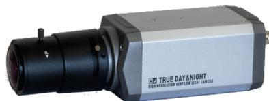
Die L-BN-2501 ist eine HD-CVI Box-Kamera. Passende Objektive (nicht im Lieferumfang) werden über CS angeschlossen. Der DSP (Signalprozessor) der Kamera ermöglicht zahlreiche Einstellungen für optimale Bildqualität auch bei schwierigen Lichtverhältnissen. Das OSD-Menü der Kamera wird über den Rekorder gesteuert. Die Spannungsversorgung erfolgt über 230 V AC.
